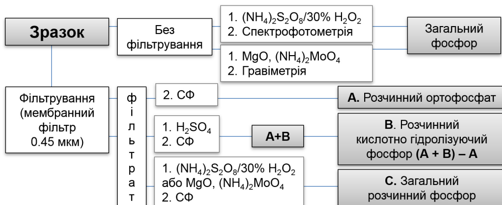
Схема 1. Постадійний аналіз фракцій фосфору [16], де пункти 1 – необхідна пробо підготовка, 2 – спосіб детектування аналітичного відгуку (AB) відповідно.
