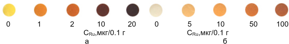
Рис. 11. Фотографии цветowych шкал на поверхности МФС (а) и АБТС (б) после сорбции Ru(IV) из растворов HCl (C(SnCl 2 )=0.1 М; 1 М HCl; V=10 мл; 0.1 г сорбента; T=95 °С; время контакта фаз, мин; 10 (а), 60 (б).
